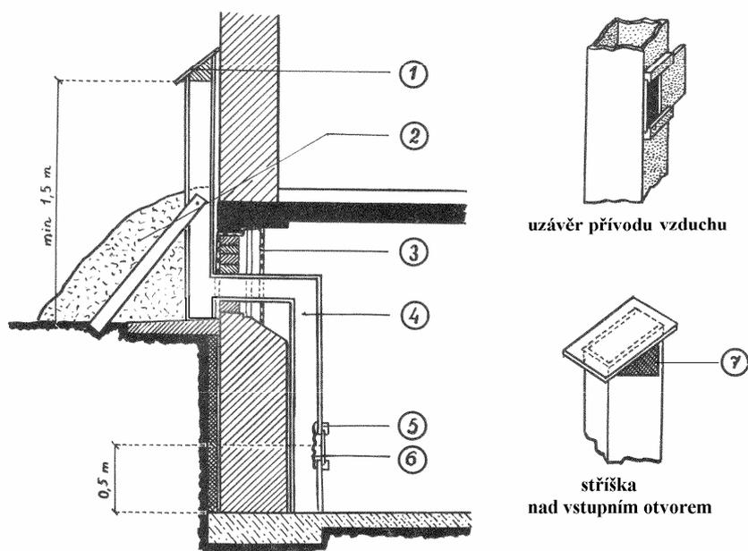
1 - stříška, 2 - zemní násyp, 3 - těsnící fólie, 4 - komínek, 5 - uzavírací klapka,
